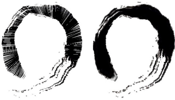
図2 補間アルゴリズム (左:補間前 右:補間後)
